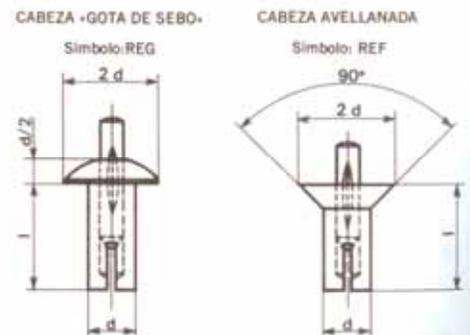
Ejemplo de designación dimensional de un remache expansible de cabeza de «gota de sebo», de cotas  $d = 5$  y  $l = 10$ :
